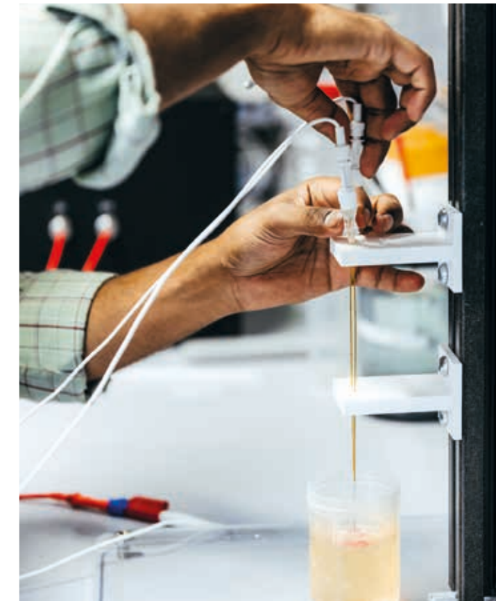
Mit Partnern des Forschungscampus Stimulate werden mit Gewebemodellen neue Elektroden für die Ablation von Tumoren entwickelt. Foto: Jana Dünnhaupt
