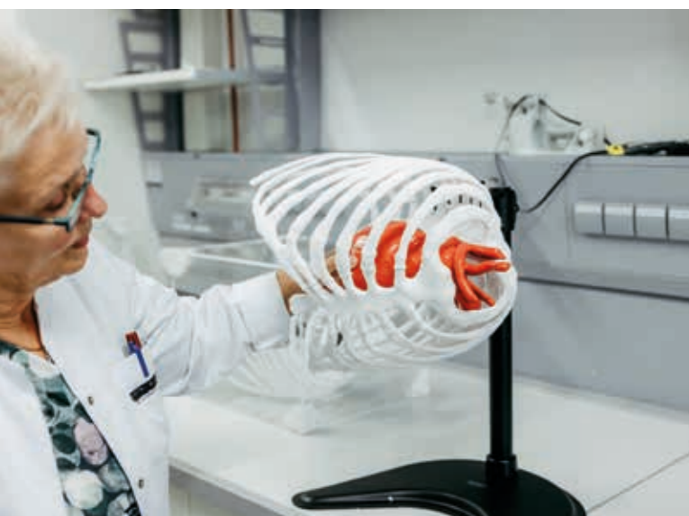
Mit Hilfe eines gedruckten Herzens wird geprüft, ob die Abmaße im Thorax stimmen. Danach werden entsprechende lebende Gewebemodelle aufgebaut und integriert, so entsteht Schritt für Schritt ein Biophantom als Alternative zum Tiermodell. Foto: Jana Dünnhaupt
